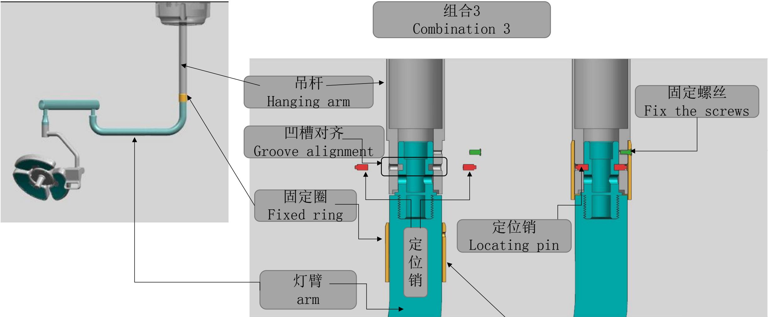
吊杆。灯臂连接之前将**固定圈**套入灯臂，对齐黑色框标识凹槽，放入定位销，注意小头向外，上移固定圈，用螺丝固定。
